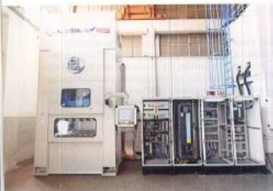
Die neue Pressenlinie „Servo“ ist für Presskräfte von 100 t bis 1.000 t konzipiert. Die abgebildete Presse ist für 150 t und 150 Hub pro Minute ausgelegt.
